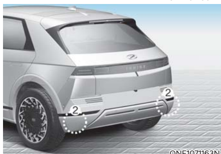
[1] : Caméra avant, [2] : Radar latéral arrière
