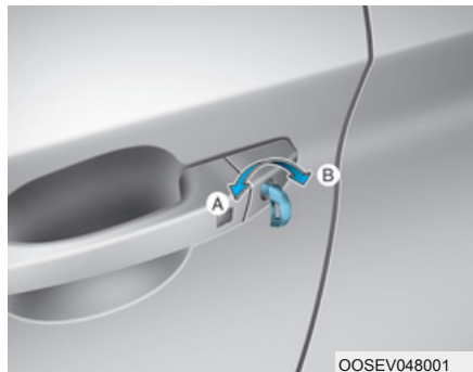
[A]: Lock, [B]: Déverrouillez
