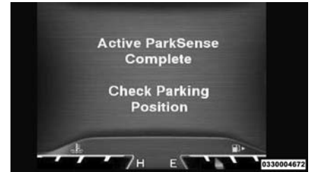
Active ParkSense Complete – Check Parking Position (Manœuvre du système d'aide au stationnement ParkSense terminée, vérifier la position de stationnement)
