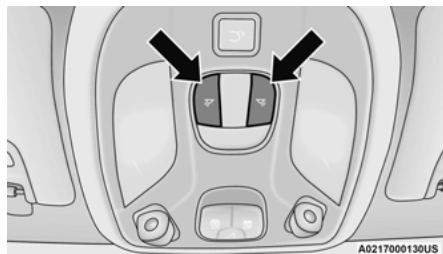
Commutateurs d'éclairage au pavillon
