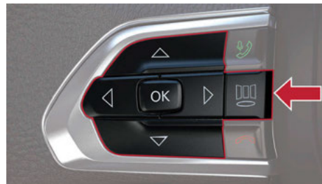
Boutons de commande d'affichage du groupe d'instruments haut de gamme
