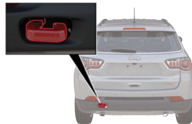
Emplacement du crochet de remorquage arrière
