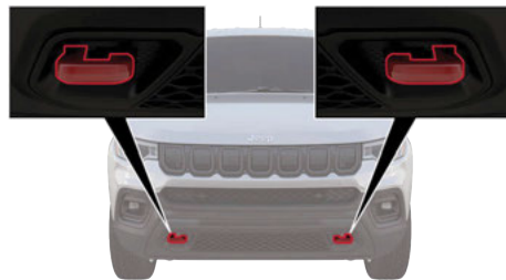
Emplacement des crochets de remorquage avant
