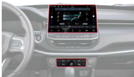
Commandes de climatisation automatique de l'écran Uconnect 5
