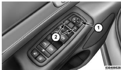
Commutateur des rétroviseurs à commande électrique
