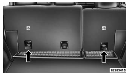
Ancrage de sangle d'attache supérieure (situé au dossier du siège)
