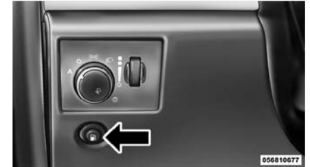
Commutateur de déverrouillage du volet de remplissage de carburant
