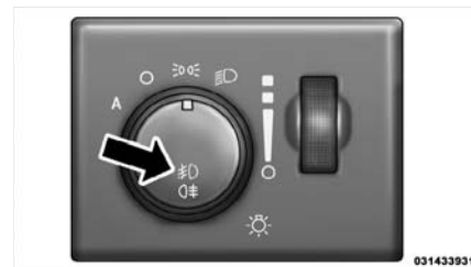
Fonctionnement des feux antibrouillard
