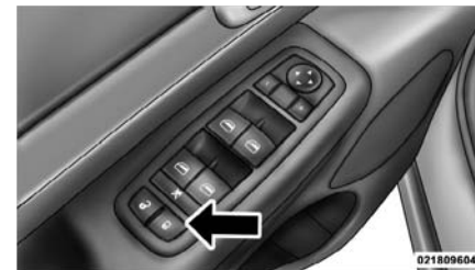
Commutateur de verrouillage électrique des portes
