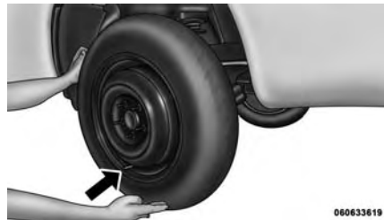
Montage de la roue de secours
