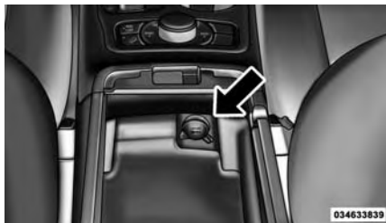
Prise de courant de la console centrale
