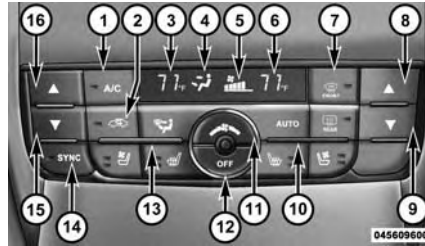
Panneau du système de commande automatique de température
