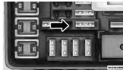
Fusible de la prise du panneau de custode arrière droit
