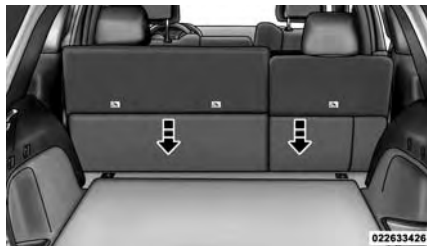
Accès à l'ancrage de courroie d'attache supérieure en tirant vers le bas sur le panneau de plancher recouvert de moquette
