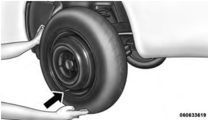
Montage de la roue de secours
