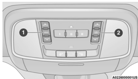
Commutateurs de toit ouvrant CommandView et de pare-soleil à commande électrique
