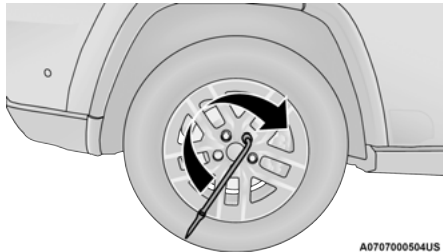
Serrez les écrous de roue
