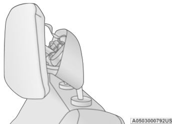
Système d'appuie-tête actif déployé
