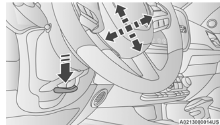
Commande manuelle de la colonne de direction inclinable et télescopique
