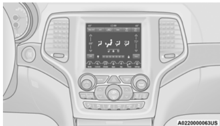
Menu des commandes automatiques du système de chauffage-climatisation du système Uconnect 4C et 4C AVEC NAVIGATION avec affichage de 8,4 pouces
