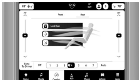
Commandes arrière du panneau de contrôle automatique de la température avant du système Uconnect 5/5 NAVIGATION avec écran de 8,4 pouces
