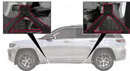
Emplacements de levage
