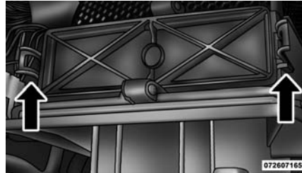
Remplacement du filtre à air du climatiseur
