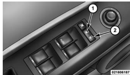
Commutateur de verrouillage électrique des portes du conducteur
