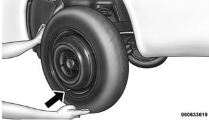
Montage de la roue de secours
