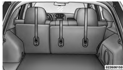
Emplacements des ancrages d'attache
