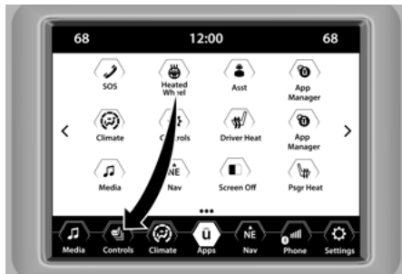
Fonction glisser-déplacer avec le système Uconnect 4, 4C et 4C NAVIGATION avec écran de 8,4 pouces
