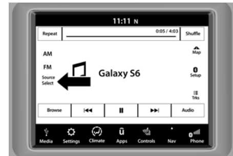
Sélection de la source du système Uconnect 4, 4C ou 4C NAVIGATION avec écran de 8,4 pouces
