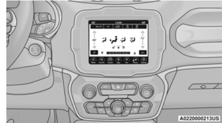
Commandes de chauffage-climatisation automatique du système Uconnect 4C AVEC NAVIGATION avec affichage de 8,4 pouces
