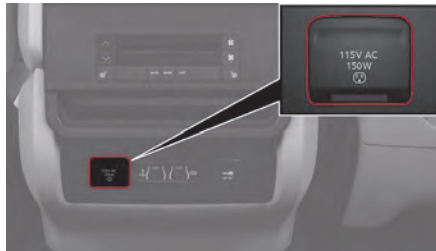
Commande électrique Onduleur
