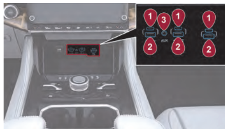
Ports USB et AUX de la passerelle multimédia avant - Sans écran du passager
