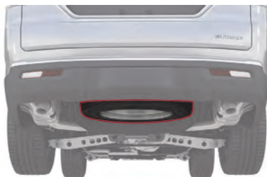
Emplacement de la roue de secours
