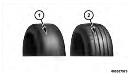
1 – Pneu usé 2 – Pneu neuf
