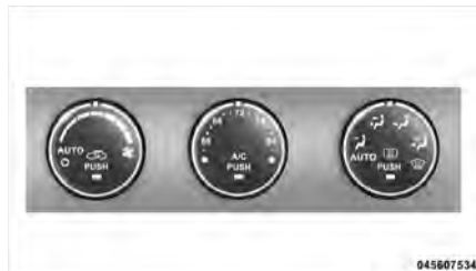
Commande automatique de température
