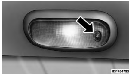
Éclairage de l'espace de chargement
