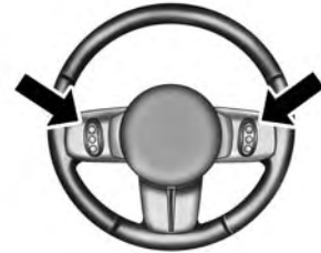
Commandes à distance du système audio (vue arrière du volant)
