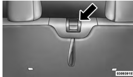
Débloccage du siège arrière
