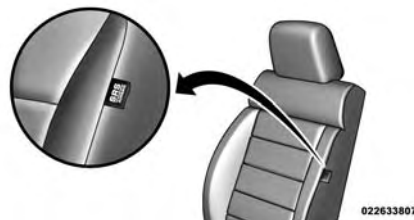
Emplacement des sacs gonflables latéraux supplémentaires montés dans les sièges
