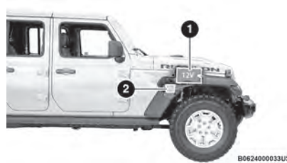
Emplacements des batteries
