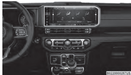
Commandes automatiques de chauffage-climatisation Uconnect 5 NAV avec affichage de 12,3 pouces
