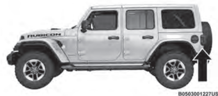
Emplacement du radar BSM (côté gauche illustré)
