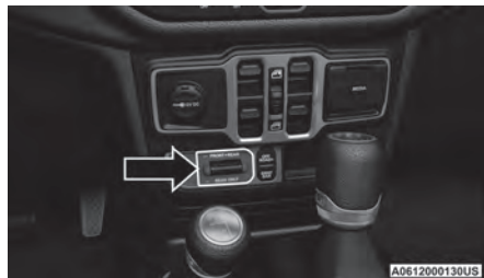
Panneau de commutateurs de verrouillage d'essieu
