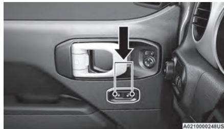
Commutateur de verrouillage électrique des portes
