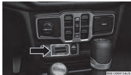
Panneau de commutateurs de verrouillage d'essieu
