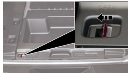
Loquet du couvercle de l'espace de rangement du matériel
