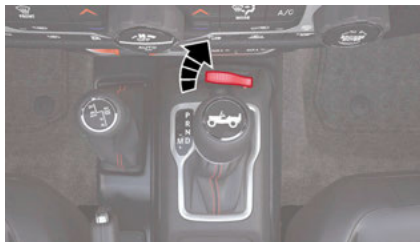
Position desserrée verticale
