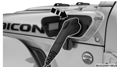
Insertion du connecteur de charge dans l'entrée de chargement du véhicule
