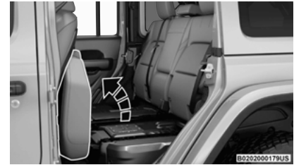
Repliez la partie inférieure du siège vers l'avant
