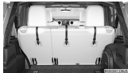
Montage de la courroie d'attache (modèles à 4 portières sans accoudoir central)
