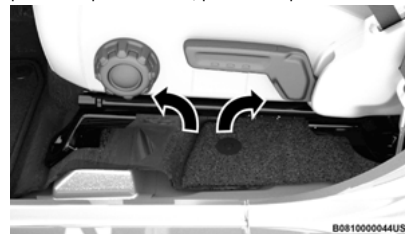
Séparation des moquettes avant et arrière
