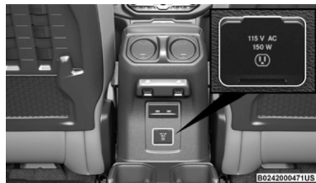
Commande électrique Onduleur
