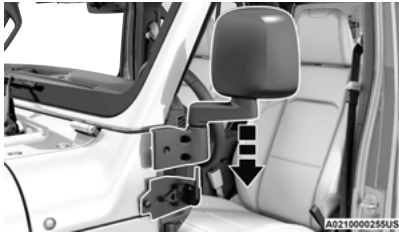
Abaisser l'ensemble du rétroviseur sur le support
