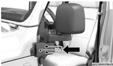
Emplacements des vis de rétroviseur
