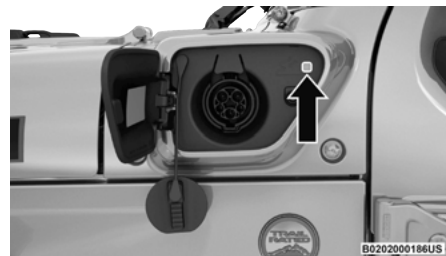
Emplacement du témoin à DEL voisin de la prise de recharge
