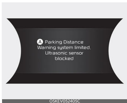
A : Système d'avertissement de distance de stationnement limité. Capteur à ultrasons bloqué
