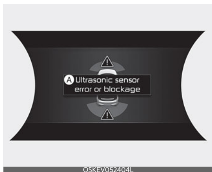
A : Erreur ou obstruction du capteur à ultrasons
