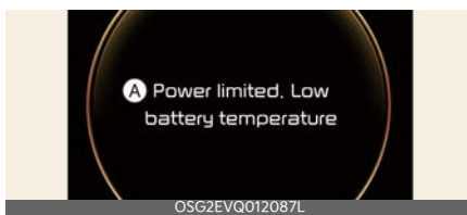
A : Puissance limitée. Température de batterie basse
