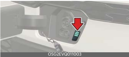
Porte de charge électrique
