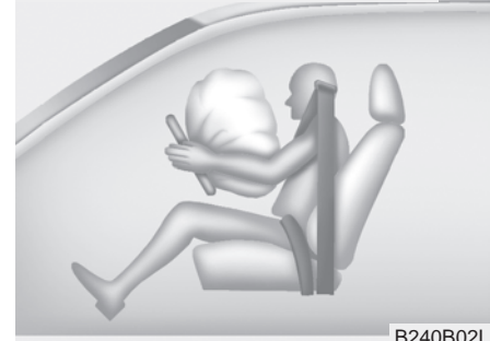
Coussin gonflable avant du conducteur (2)
