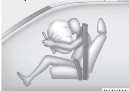
Coussin gonflable avant du conducteur (3)
