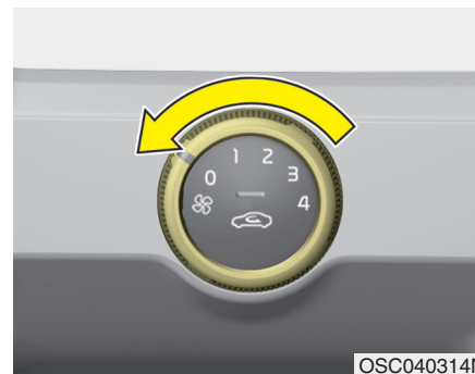
Pour éteindre les ventilateurs
