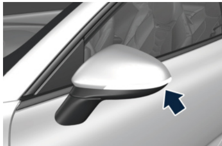
Feux intégrés des rétroviseurs externes Des clignotants à LED sont intégrés au support des rétroviseurs externes.
