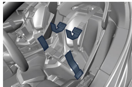
Ceintures de sécurité à quatre points pour une utilisation sur route
