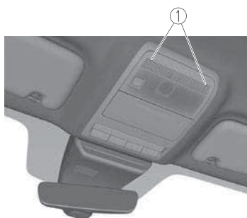
1. Détecteur d'intrusion et collerette du détecteur d'intrusion
