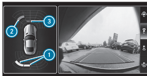
Affichage d'alerte de l'assistant de stationnement PARKTRONIC (véhicules équipés d'une caméra avant et d'une caméra de recul)
