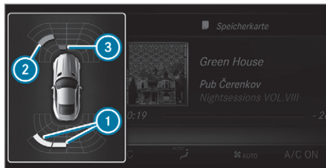
Affichage d'alerte de l'assistant de stationnement PARKTRONIC (véhicules sans caméra avant et caméra de recul)
