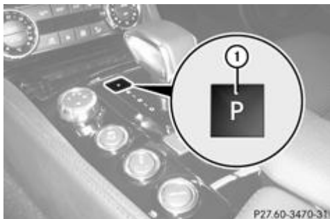
Levier sélecteur - véhicules AMG équipés d'une touche P
