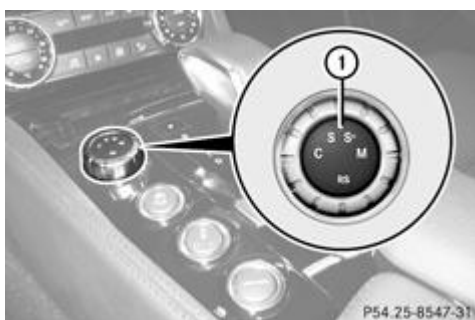
Sélecteur du programme de conduite avec programme de conduite manuel
