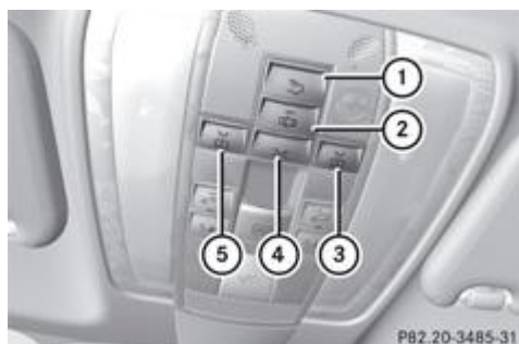
Unité de commande au plafonnier (exemple : coupé)
