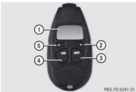
Télécommande du chauffage additionnel
