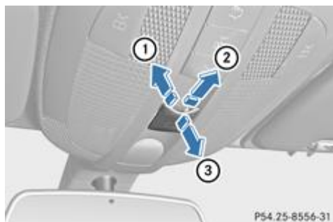
Unité de commande au plafonnier
