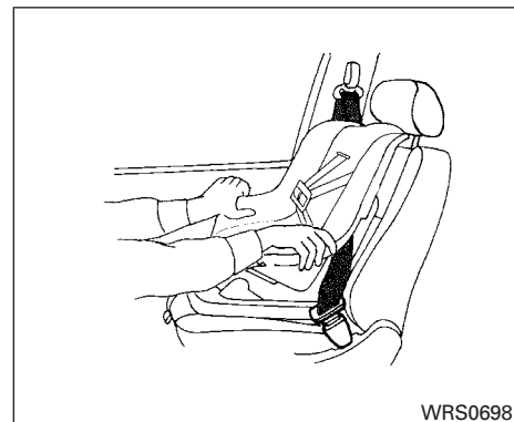
Ensemble de retenue orienté vers l'avant, étape 8
