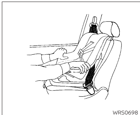
Ensemble de retenue orienté vers l'avant, étape 8
