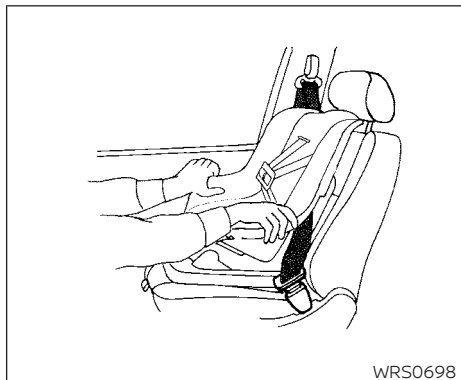
Ensemble de retenue orienté vers l'avant, étape 8
