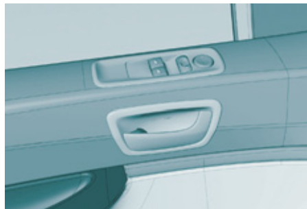
Ouverture des portes de l'intérieur
