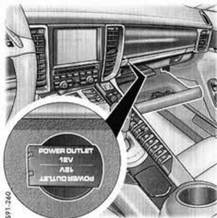
Prise électrique de la boîte à gants
