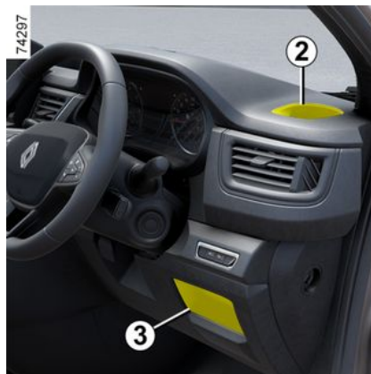
Rangements poste de conduite à droite 2 et 3
