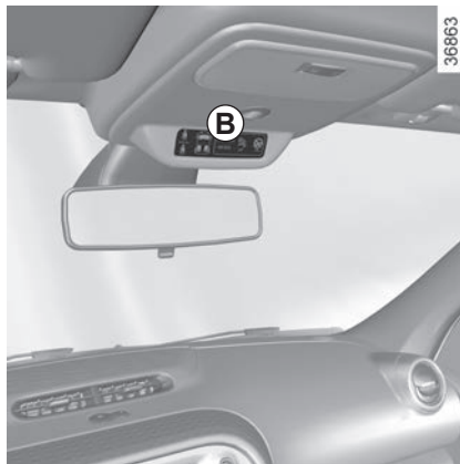
Afficheur central B : il s'éclaire à la mise sous contact.
