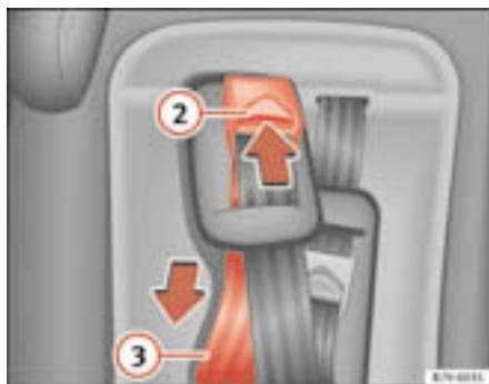
Fig. 39 Détail d'un siège intégré pour enfants : réglage du harnais de sécurité
