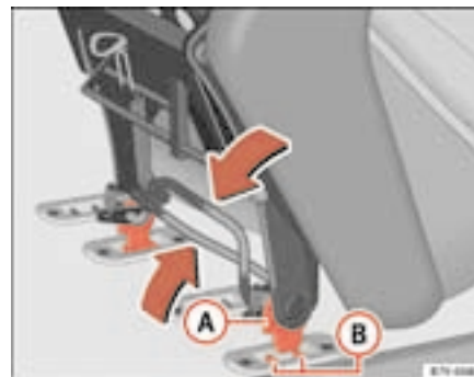
Fig. 94 Montage du siège : étriers et boulons
