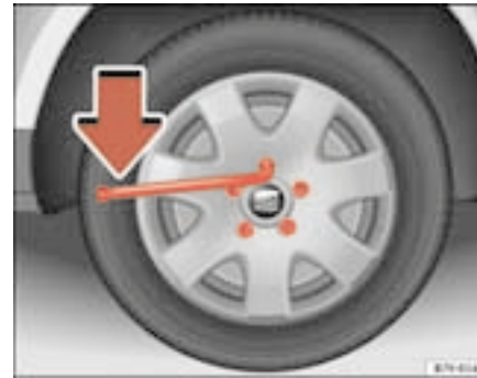
Fig. 159 Changement d'une roue : desserrage des boulons de roue
