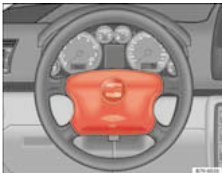
Fig. 22 Emplacement de montage de l'airbag du conducteur : dans le volant de direction
