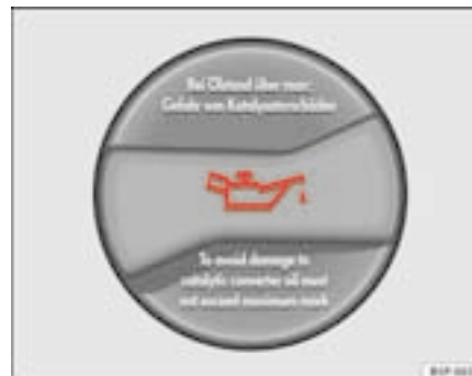
Fig. 143 Dans le compartiment-moteur : bouchon de l'orifice de remplissage d'huile-moteur ▶
