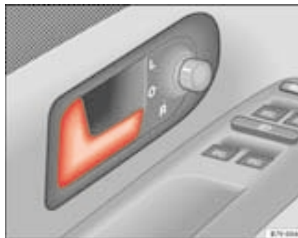
Fig. 58 Levier d'ouverture de porte du conducteur dans la position normale
