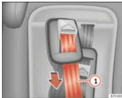
Fig. 38 Détail d'un siège intégré pour enfants : réglage du harnais de sécurité
