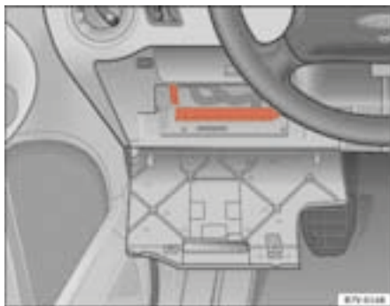
Fig. 163 Boîtier des fusibles : à gauche dans le tableau de bord
