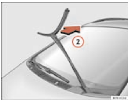
Fig. 147 Démontage des essuie-glaces avant
