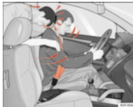
Fig. 8 Le passager arrière non sanglé est projeté en avant et vient heurter le conducteur sanglé.
