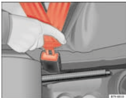
Fig. 10 Boîtier de verrouillage et pêne de la ceinture de sécurité
