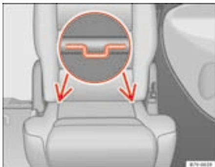
Fig. 33 Œillets de retenue pour les sièges ISOFIX pour enfants sur le cadre d'assise de la seconde rangée
