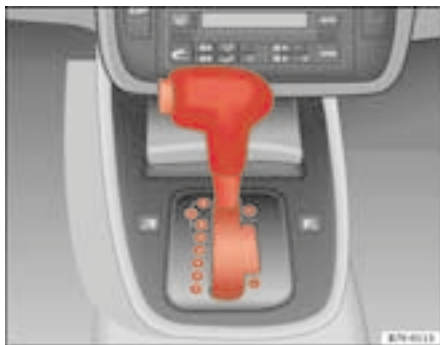
Fig. 130 Détail de la console centrale : levier sélecteur avec touche de blocage
