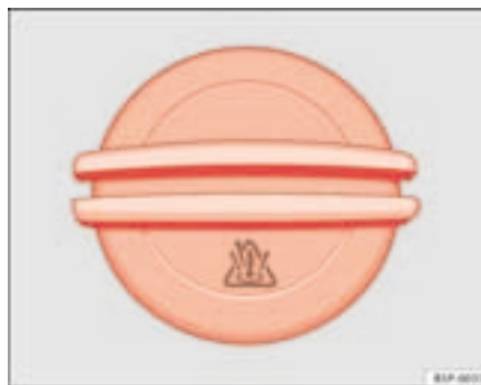
Fig. 144 Dans le compartiment-moteur : bouchon du vase d'expansion du liquide de refroidissement
