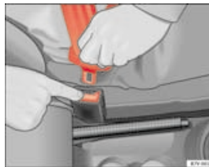
Fig. 16 Libération du pêne du boîtier de verrouillage
