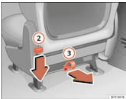
Fig. 92 Partie arrière du siège : rabattre le dossier et soulever le siège.
