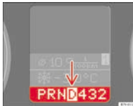
Fig. 131 Combiné d'instruments : écran avec position actuelle du levier sélecteur
