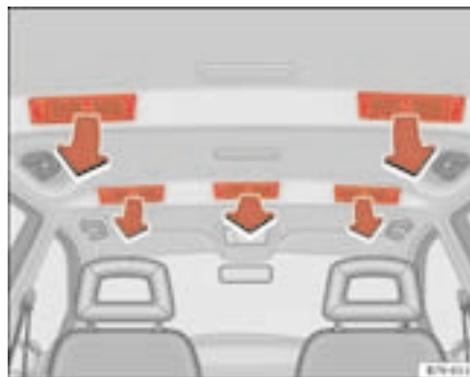
Fig. 122 Diffuseurs d'air froid sur le plafond
