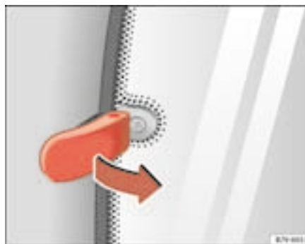
Fig. 65 Levier de blocage des glaces avec déflecteur mécanique
