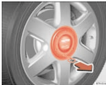
Fig. 157 Dépose de l'enjoliveur central
