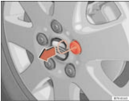
Fig. 158 Détachement du capuchon au moyen de l'étrier métallique
