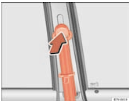
Fig. 15 Emplacement de montage du dispositif de réglage en hauteur des ceintures
