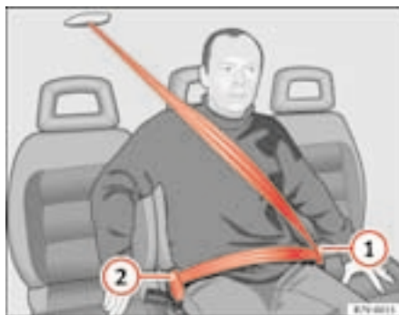
Fig.17 Débouclage d'une ceinture dotée de deux boîtiers de verrouillage
