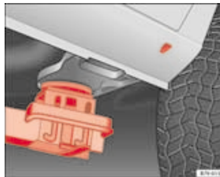
Fig. 177 Levage avec le pont élévateur : point de prise du côté arrière gauche
