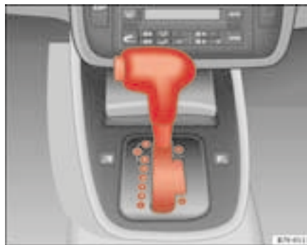
Fig. 128 Détail de la console centrale : levier sélecteur avec touche de blocage
