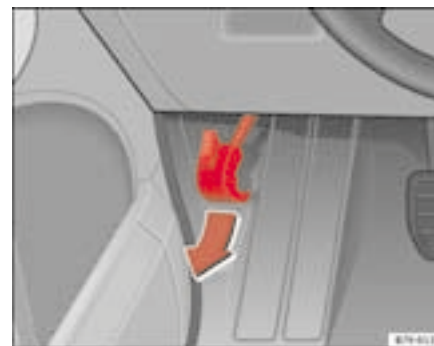
Fig. 139 Détail du plancher côté conducteur : levier de déverrouillage du capot-moteur.
