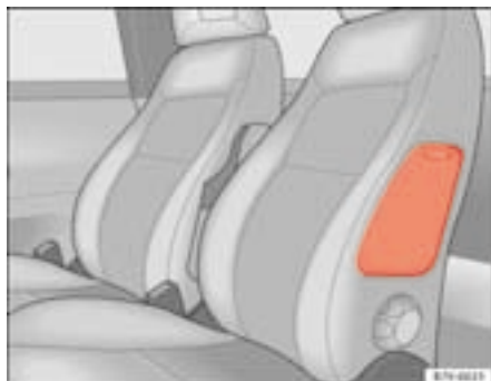
Fig. 25 Airbag latéral sur le siège arrière gauche
