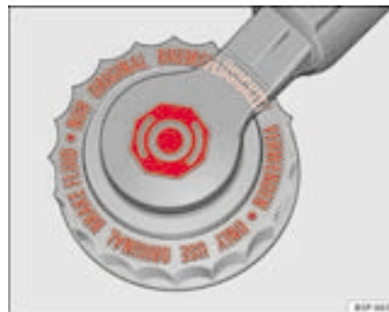
Fig. 149 Dans le compartiment-moteur : bouchon du réservoir de liquide de frein
