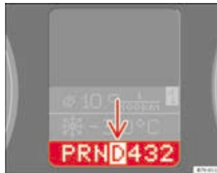
Fig. 129 Combiné d'instruments : écran avec position actuelle du levier sélecteur
