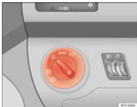
Fig. 71 Détail du tableau de bord : commandes d'éclairage, des projecteurs antibrouillard et du feu arrière de brouillard
