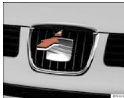
Fig. 140 Détail de la grille de calandre : ouverture du capot-moteur. ▶
