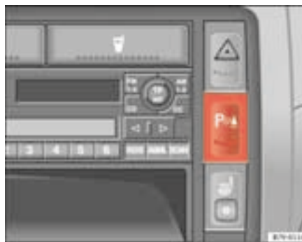
Fig. 132 Détail du tableau de bord : touche d'activation/de désactivation du système d'aide au stationnement
