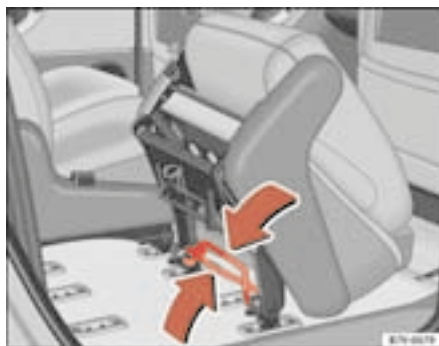
Fig. 93 Étriers pour démonter et monter le siège
