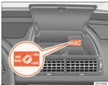
Fig. 28 Intérieur du compartiment du centre du tableau de bord : Commande à clé pour la désactivation des airbags du passager avant
