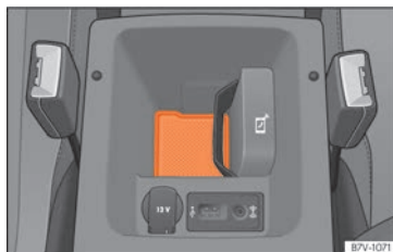
Fig. 124 Accoudoir central avant : compartiment pour la connexion du téléphone mobile à l'antenne extérieure du véhicule.
