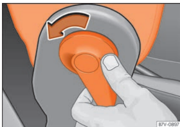
Fig. 164 Débloquer le dossier rabattable du siège du passager avant.
