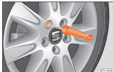
Fig. 73 Changement de roue : desserrer les boulons de la roue avec le manche du tournevis.
