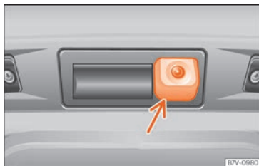
Fig. 253 Dans le hayon arrière : emplacement de la caméra de l'assistant de marche arrière.
