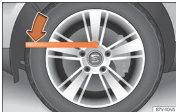
Fig. 69 Changement de roue : desserrez les boulons de la roue.
