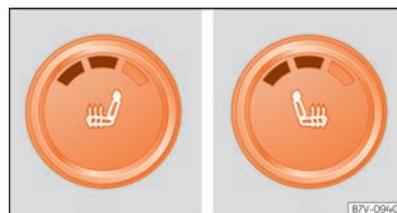
Fig. 158 Détail de la console centrale : commandes pour le chauffage des sièges avant, dans notre cas avec le second niveau de température activé.
