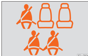
Fig. 85 Exemple d'indication de l'état de la ceinture pour les places arrière (dans le cas présent, véhicule à 7 places) sur le tableau de bord, en haut, deuxième rangée ; en bas, troisième rangée de sièges.
