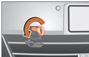
Fig. 74 Sur la partie droite du pare-chocs avant : visser l'œillet de remorquage.
