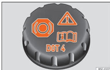
Fig. 59 Compartiment-moteur : bouchon du réservoir du liquide de frein.
