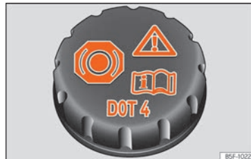
Fig. 296 Dans le compartiment moteur : bouchon du réservoir du liquide de frein.
