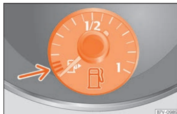
Fig. 285 Sur le tableau de bord : indicateur de niveau de carburant pour essence et diesel.
