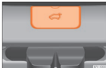
Fig. 10 Dans le coffre à bagages : démontage du cache du hayon arrière.
