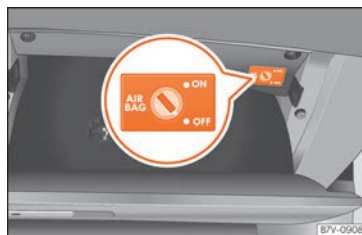
Fig. 94 Dans la boîte à gants, côté passager : commande à clé pour activer et désactiver l'airbag frontal côté passager.
