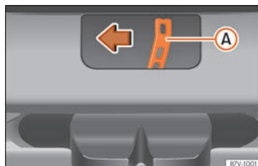
Fig. 11 Dans le coffre à bagages : déverrouillage d'urgence du hayon arrière.
