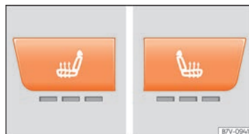
Fig. 159 Détail de la console centrale : commandes de chauffage des sièges avant sur les véhicules équipés de Climatronic.
