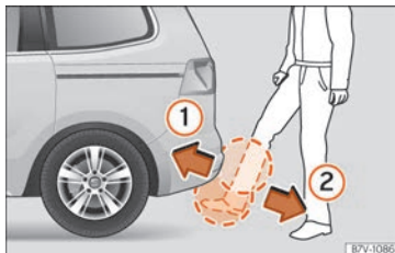
Fig. 142 Hayon du coffre à bagages à ouverture contrôlée par capteur (Easy Open).
