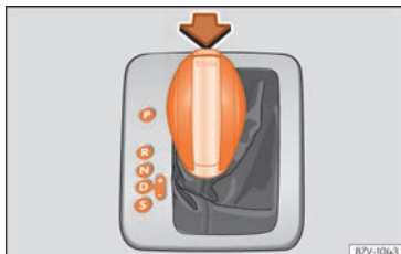
Fig. 241 levier sélecteur de la BV automatique avec touche de blocage (flèche).
