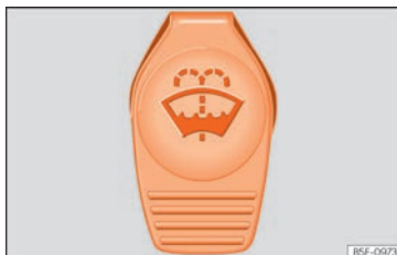
Fig. 60 Dans le compartiment moteur : bouchon du réservoir de liquide lave-glace.
