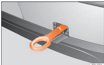
Fig. 106 Sur le pare-chocs arrière, côté droit : œillet de remorquage vissé.
