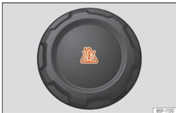
Fig. 295 Dans le compartiment moteur : bouchon du vase d'expansion du liquide de refroidissement.
