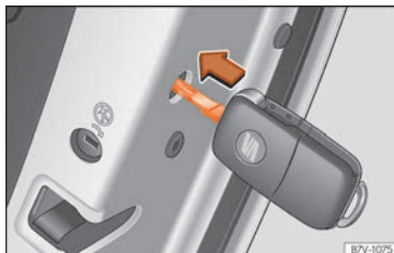
Fig. 7 Verrouillage de secours du véhicule avec la clé de celui-ci.
