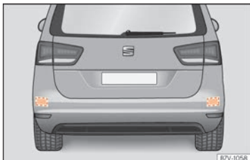
Fig. 272 Vue arrière du véhicule : zones des capteurs radars.
