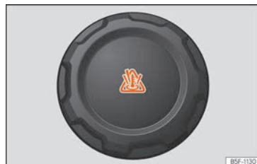
Fig. 58 Compartiment-moteur : bouchon du vase d'expansion du liquide de refroidissement.
