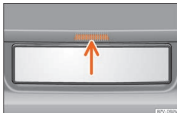
Fig. 141 Ouverture du hayon arrière depuis l'extérieur.
