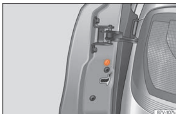
Fig. 6 Sur la face avant de la porte coulissante : verrouillage d'urgence, caché par un joint en caoutchouc.
