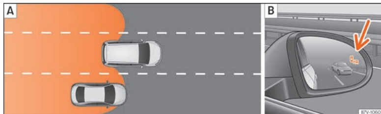
Fig. 274 Représentation schématique : A En cas de dépassement puis de retour sur la voie de droite. B Indication de l'assistant d'angle mort sur le rétroviseur extérieur droit.
