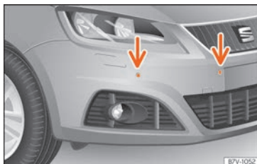
Fig. 247 Capteurs du système d'aide au stationnement dans le pare-chocs avant.
