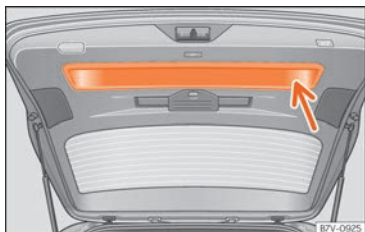
Fig. 139 Hayon arrière ouvert : cavité pour tirer.
