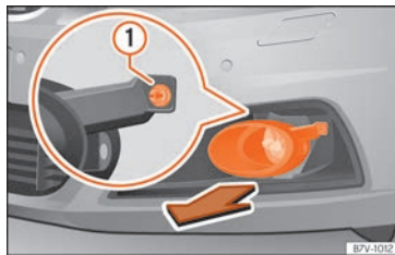
Fig. 111 Sur la partie droite du pare-chocs avant : démontage des phares.
