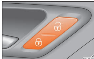
Fig. 132 Sur la porte du conducteur : touche de verrouillage centralisé.
