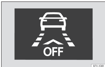
Fig. 260 Sur l'écran du combiné d'instruments : indication de Front Assist désactivé.
