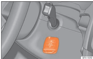
Fig. 238 Démarrage d'urgence sur les véhicules équipés de Keyless Access.
