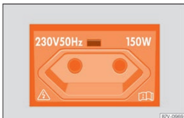
Fig. 198 Détail de la console centrale arrière : prise de courant européenne de 230 volts.
