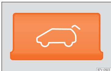
Fig. 8 Détail de la console centrale : touche de déverrouillage du hayon arrière.
