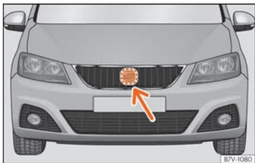
Fig. 263 Sur la face du véhicule derrière l'emblème SEAT : capteur radar.
