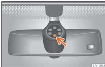
Fig. 149 Surface sensible du détecteur de pluie.
