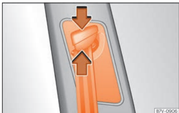
Fig. 92 Près des sièges avant : dispositif de réglage en hauteur de la ceinture.
