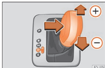
Fig. 242 Levier sélecteur sur la position Tiptronic (véhicules avec volant à gauche). Les véhicules avec le volant à droite sont disposés de manière symétrique.
