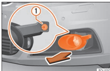
Fig. 66 Sur la partie droite du pare-chocs avant : démontage des phares.
