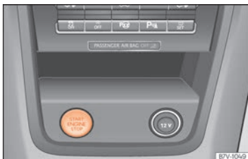
Fig. 234 Sur la console centrale : bouton de démarrage du système de fermeture et démarrage sans clé Keyless Access. Sur les véhicules avec le volant à droite, le réglage est symétrique.
