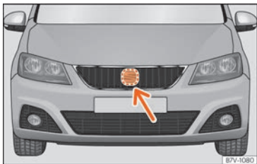
Fig. 251 Sur la face du véhicule derrière l'émblème SEAT : capteur radar.
