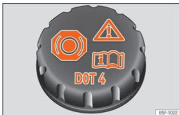
Fig. 293 Compartiment-moteur : bouchon du réservoir du liquide de frein.
