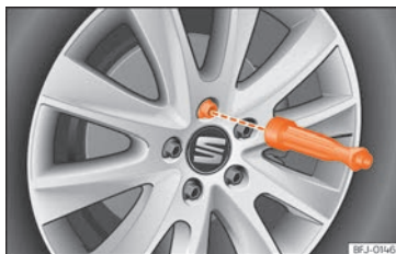
Fig. 49 Changement de roue : dévisser les boulons de roue avec le manche du tournevis.
