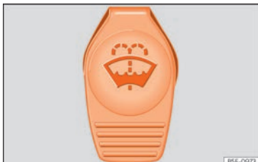
Fig. 294 Dans le compartiment-moteur : bouchon du réservoir de liquide lave-glace.
