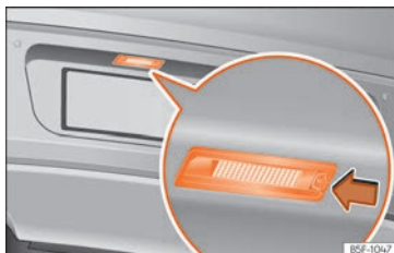
Fig. 72 Sur le pare-chocs arrière : éclairage de la plaque d'immatriculation.
