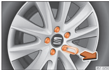
Fig. 43 Roue : boulons de roue avec capuchons.
