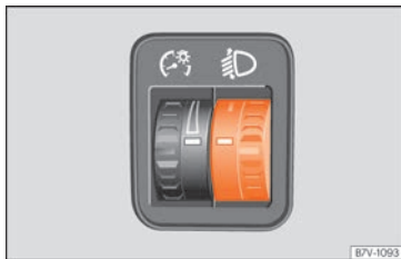
Fig. 118 Côté volant : dispositif de réglage de la portée des phares.
