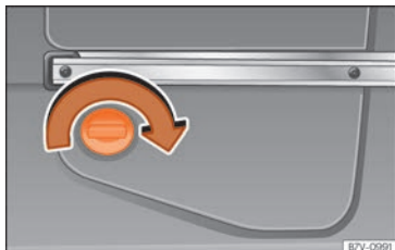
Fig. 284 Dans la partie arrière gauche du coffre : réservoir d'AdBlue, derrière un couvercle.
