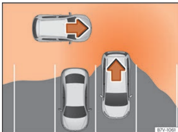
Fig. 264 Représentation schématique de l'assistant de sortie de stationnement : zone surveillée autour du véhicule sortant de stationnement.
