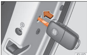
Fig. 97 Verrouillage de secours du véhicule avec la clé de celui-ci.
