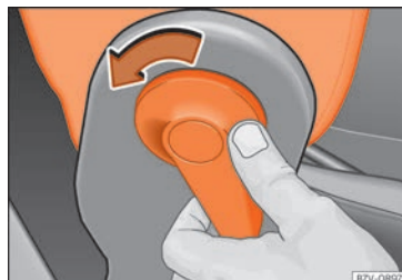
Fig. 139 Débloquer le dossier rabattable du siège du passager.
