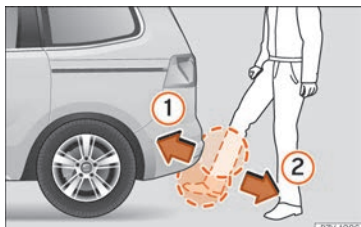
Fig. 106 Hayon du coffre à bagages à ouverture contrôlée par capteur (Easy Open).
