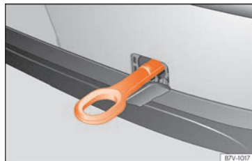
Fig. 57 Du côté droit du pare-chocs arrière : œillet de remorquage vissé.
