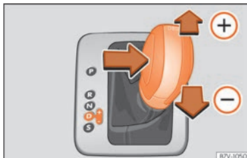
Fig. 239 Levier sélecteur sur la position Tiptronic (véhicules avec volant à gauche). Les véhicules avec le volant à droite sont disposés de manière symétrique.
