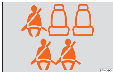
Fig. 6 Exemple d'indication de l'état de la ceinture pour les places arrière (dans le cas présent, véhicule à 7 places) sur le tableau de bord. : en haut, deuxième rangée ; en bas, troisième rangée de sièges.
