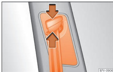
Fig. 15 Près des sièges avant : dispositif de réglage en hauteur de la ceinture.
