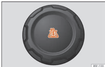
Fig. 292 Compartiment-moteur : bouchon du vase d'expansion du liquide de refroidissement.
