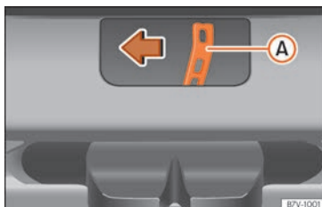
Fig. 108 Détail du coffre à bagages : déverrouillage d'urgence.
