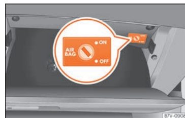
Fig. 18 Dans la boîte à gants, côté passager : commande à clé pour activer et désactiver l'airbag frontal côté passager.
