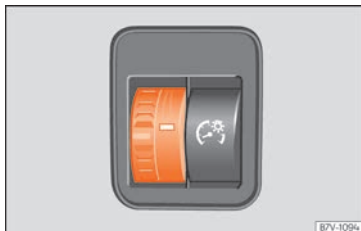
Fig. 119 Côté volant : régulateur de l'éclairage des cadrants et des commandes
