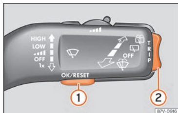
Fig. 81 Levier d'essuie-glace : touches pour utiliser les menus du tableau de bord.
