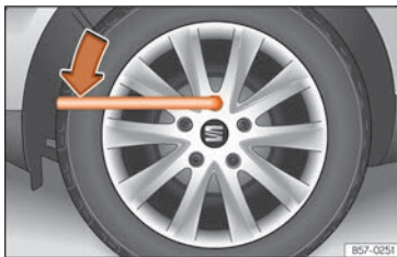
Fig. 45 Changelement de roue : desserrer les vis de roue.
