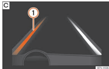
Fig. 258 Sur l'écran du tableau de bord : indication sur l'écran de l'assistant de maintien de voie (exemple 2).
