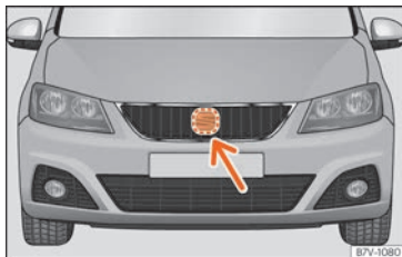
Fig. 247 Sur la face du véhicule derrière l'emblème SEAT : capteur radar.
