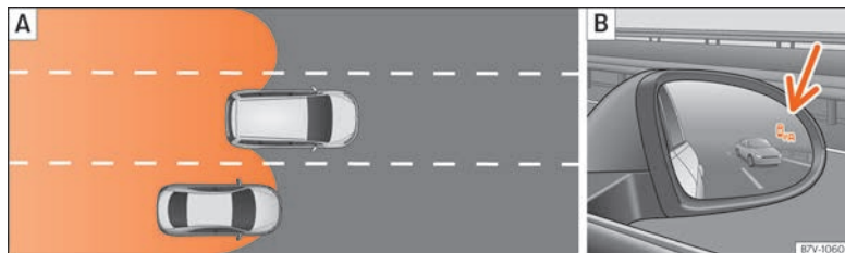
Fig. 263 Représentation schématique : A En cas de dépassement puis de retour sur la voie de droite. B Indication de l'assistant d'angle mort sur le rétroviseur extérieur droit.
