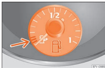
Fig. 78 Sur le tableau de bord : indicateur de niveau de carburant pour essence et diesel.
