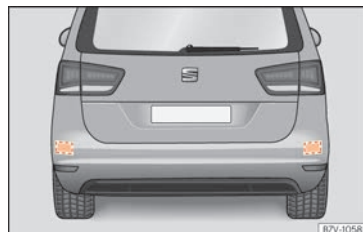
Fig. 261 Vue arrière du véhicule : zones des capteurs radars.
