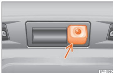
Fig. 275 Dans le hayon arrière : emplacement de la caméra de l'assistant de marche arrière.
