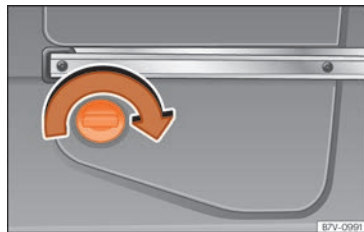
Fig. 283 Dans la partie arrière gauche du coffre : réservoir d'AdBlue, derrière un couvercle.
