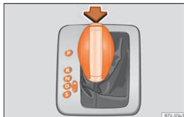
Fig. 238 Levier sélecteur de la BV automatique avec touche de blocage (flèche).
