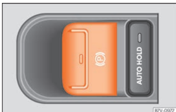
Fig. 266 Sur la console centrale : touche du frein de stationnement électronique.
