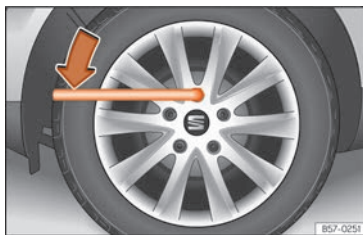
Fig. 45 Change de roue : desserrer les vis de roue.
