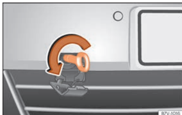
Fig. 56 Sur la partie droite du pare-chocs avant : visser l'œillet de remorquage.
