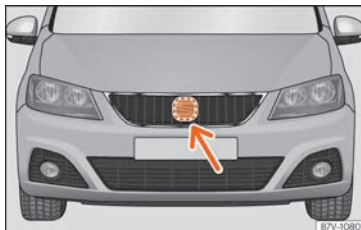
Fig. 244 Au niveau du pare-chocs avant : : capteur radar.
