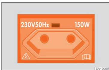
Fig. 172 Détail de la console centrale arrière : prise de courant européenne de 230 volts.
