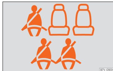
Fig. 6 Exemple d'indication de l'état de la ceinture pour les places arrière (dans le cas présent, véhicule à 7 places) sur le combiné d'instruments : en haut, deuxième rangée ; en bas, troisième rangée de sièges.
