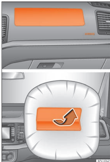
Fig. 17 Airbag du passager avant dans le combiné d'instruments.
