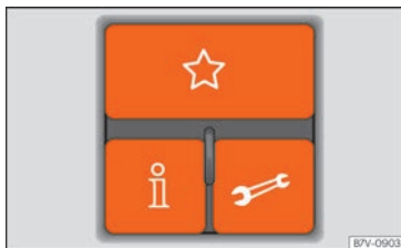
Fig. 85 Plafonnier à trois touches du pavillon : éléments de commande du système de gestion du téléphone
