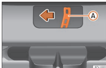
Fig. 108 Détail du coffre à bagages : déverrouillage d'urgence.
