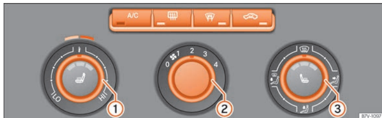
Fig. 174 Sur la console centrale : commandes du climatiseur manuel.
