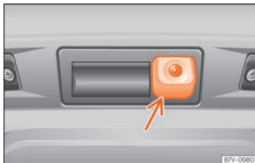
Fig. 249 Sur le pare-chocs arrière : emplacement de la caméra de l'assistant de marche arrière.
