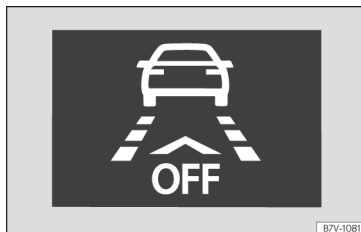
Fig. 253 Sur l'écran du combiné d'instruments : indication de Front Assist désactivé.
