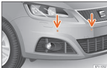
Fig. 272 Capteurs du système d'aide au stationnement dans le pare-chocs avant.
