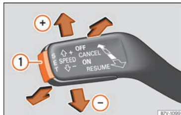
Fig. 251 À gauche de la colonne de direction : troisième levier pour utiliser l'GRA.
