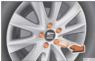
Fig. 43 Roue : boulons de roue avec capuchons.
