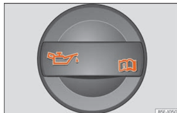
Fig. 289 Dans le compartiment-moteur : bouchon de l'orifice de remplissage d'huile moteur.
