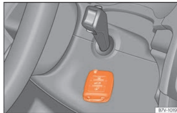
Fig. 235 Démarrage d'urgence sur les véhicules équipés de Keyless Access.
