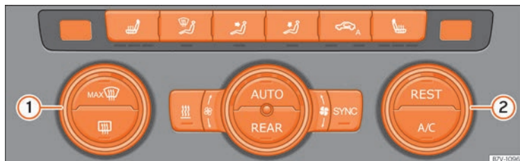
Fig. 173 Sur la console centrale : commandes du Climatronic.
