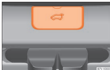
Fig. 107 Détail du coffre à bagages : accès au déverrouillage d'urgence.
