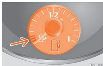
Fig. 78 Sur le combiné d'instruments : indicateur de niveau de carburant pour essence et diesel.
