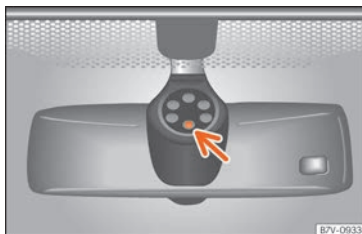
Fig. 122 Surface sensible du détecteur de pluie.
