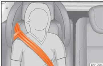
Fig. 35 Siège intégré pour enfants : parcours de la sangle de la ceinture avec poignée de guidage.
