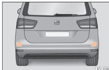
Fig. 247 Vue arrière du véhicule : zones des capteurs radars.
