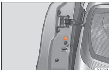
Fig. 96 Sur la face avant de la porte coulissante : verrouillage d'urgence, caché par un joint en caoutchouc.
