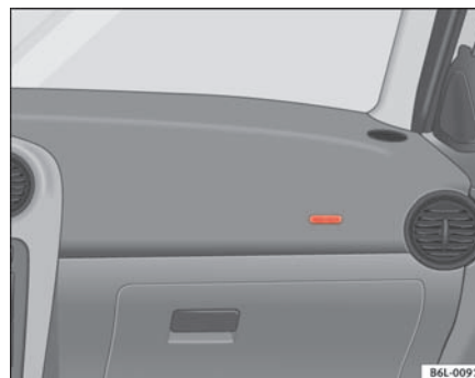
Fig. 18 Emplacement de montage de l'airbag du passager avant : dans le tableau de bord
