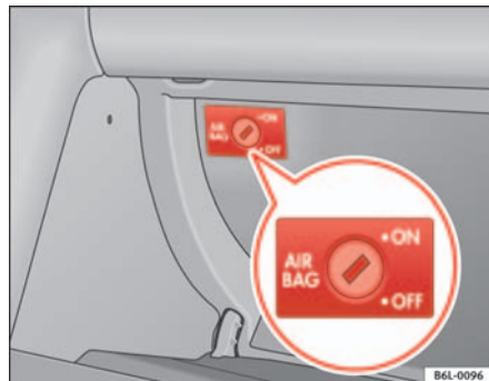
Fig. 25 Dans le vide-poches : commande à clé pour commuter et désactiver les sacs gonflables côté passager avant
