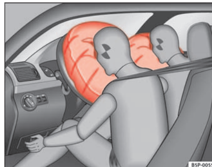
Fig. 19 Schéma de principe : airbags frontaux gonflés
