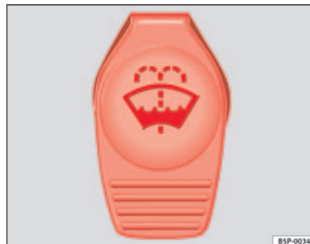
Fig. 125 Dans le compartiment-moteur : bouchon du réservoir de lave-glace
