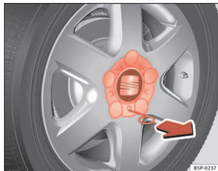
Fig. 131 Changement de roue : enlever l'enjoliveur de la roue
