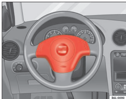
Fig. 17 Emplacement de montage de l'airbag du conducteur : dans le volant de direction
