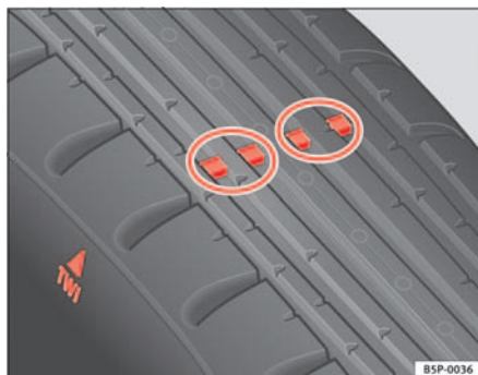
Fig. 129 Sculptures du pneu : indicateurs d'usure
