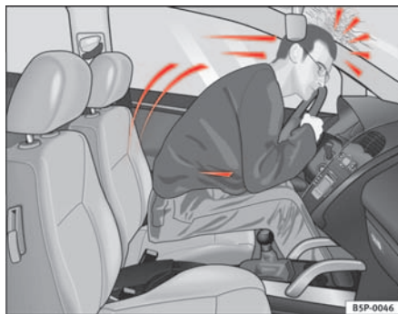
Fig. 8 Le conducteur non sanglé est projeté en avant
