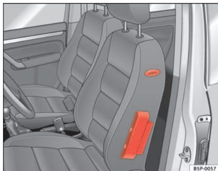
Fig. 21 Airbag latéral dans le siège du conducteur
