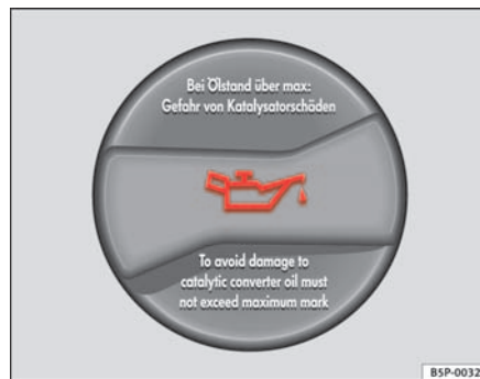
Fig. 123 Dans le compartiment-moteur : bouchon de l'orifice de remplissage d'huile-moteur
