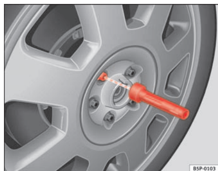
Fig. 136 Changement de roue : Outil à six pans creux pour tourner les boulons
