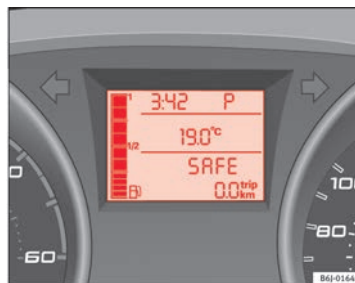
Fig. 36 Afficheur : position du levier de la boîte automatique
