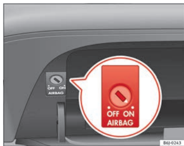
Fig. 21 Dans la boîte à gants se trouve commande à clé pour activer et désactiver les airbags côté passager avant
