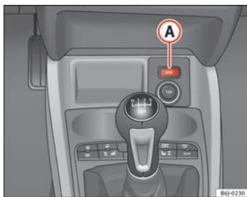
Fig. 100 Console centrale : contacteur de contrôle du système de gaz.
