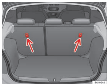
Fig. 27 Position des anneaux Top Tether sur la partie arrière de la banquette arrière
