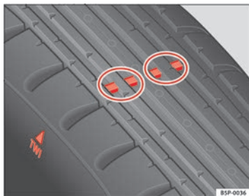
Fig. 134 Sculptures du pneu : indicateurs d'usure
