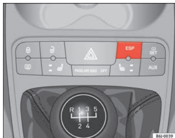
Fig. 98 Détail de la console centrale : touche ESP.
