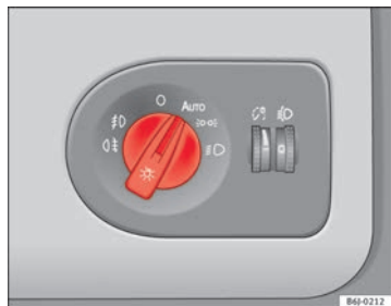
Fig. 55 Allumage automatique des feux
