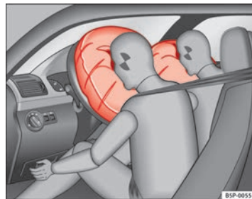
Fig. 18 Schéma de principe : airbags frontaux gonflés
