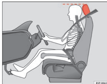
Fig. 2 Réglage correct de l'appui-tête du conducteur
