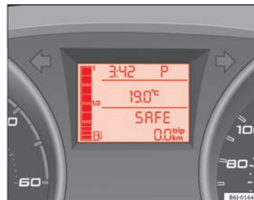
Fig. 110 Boîte automatique : Afficheur dans le tableau de bord
