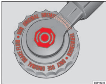
Fig. 133 Dans le compartiment moteur : bouchon du réservoir de liquide de frein
