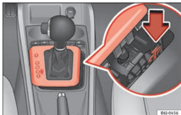
Fig. 169 Déverrouillage d'urgence du levier sélecteur.
