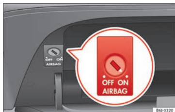
Fig. 61 Dans la boîte à gants se trouve commande à clé pour activer et désactiver l'airbag du passager avant.
