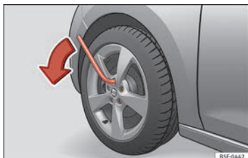
Fig. 159 Changement de roue : desserrer les vis de roue.
