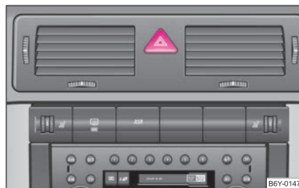
Fig. 35 Tableau de bord : Contacteur pour feux de détresse
