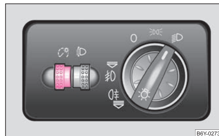
Fig. 33 Tableau de bord: Éclairage de l'instrumentation
