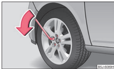
Fig. 154 Changement de roue: Desserer les boulons de roue
