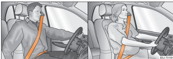
Fig. 111 Position correcte de la sangle baudrier et la sangle sous-abdominale / Position correcte de la ceinture sur les femmes enceintes
