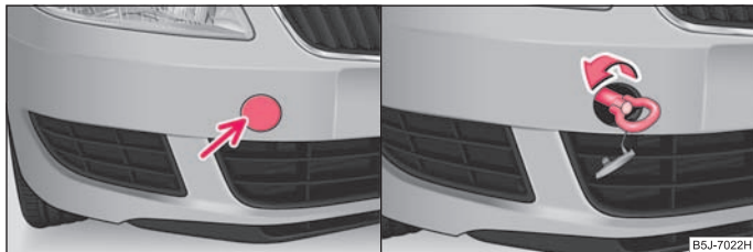
Fig. 159 Pare-chocs avant: Cache / pose de l'oeillet de remorquage
