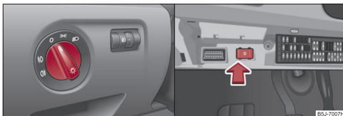
Fig. 36 Tableau de bord: Commutateur d'éclairage / Boîte à fusibles: Commutateur pour éclairage diurne
