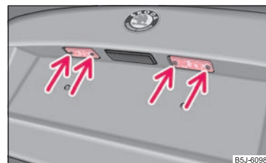
Fig. 174 Déposer l'éclairage de la plaque d'immatriculation
