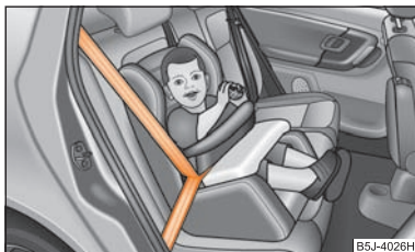
Fig. 125 Siège pour enfant monté à l'arrière dans le sens de déplacement avec tablette de sécurité selon groupe 1
