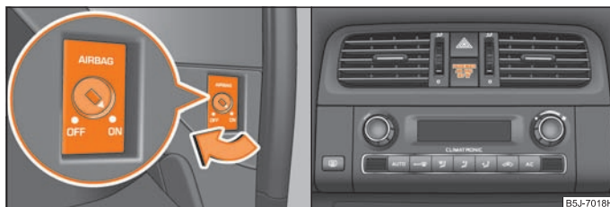
Fig. 121 Contacteur pour airbag frontal du passager avant / témoin de neutralisation de l'airbag du passager avant
