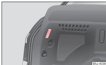
Fig. 177 Déposer l'éclairage du coffre à bagages
