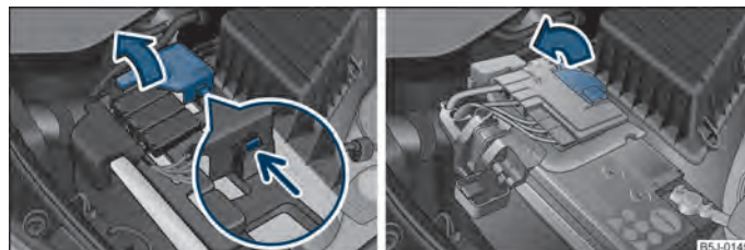
Fig. 132 Batterie: Relever le cache (boîte de vitesses automatique)/(boîte de vitesses manuelle)
