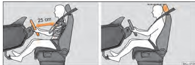
Fig. 96 Bonne distance du conducteur par rapport au volant / bon réglage de l'appuie-tête du conducteur
