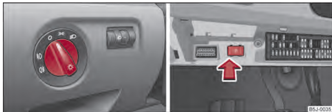
Fig. 22 Tableau de bord: Commutateur d'éclairage/Boîte à fusibles : Commutateur pour éclairage diurne
