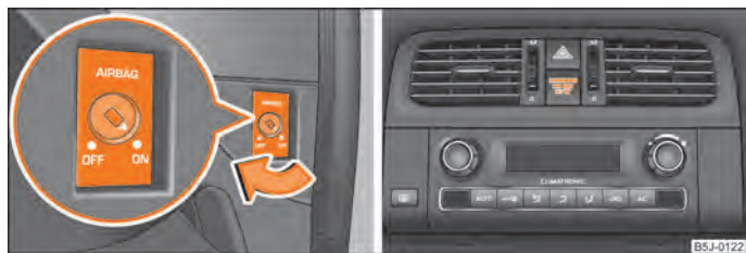
Fig. 109 Contacteur pour airbag frontal du passager avant/témoin de neutralisation de l'airbag du passager avant
