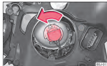
Fig. 159 Dépose de l'ampoule pour feu de croisement et de route/feu de croisement
