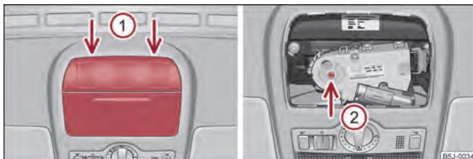
Fig. 21 Découpe dans le revêtement de pavillon: Points d'introduction du tournevis / Ouverture pour insérer la clé
