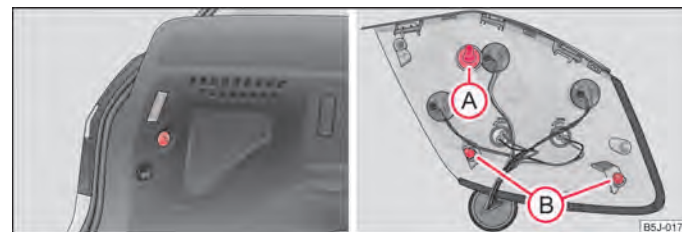
Fig. 165 Déposer le bloc optique arrière/poser le bloc optique arrière
