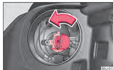
Fig. 160 Dépose de l'ampoule pour feu de route
