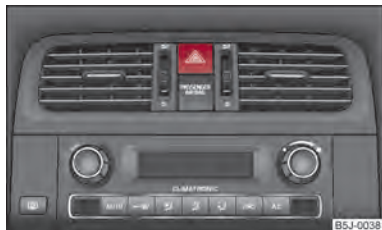
Fig. 25 Tableau de bord: Contacteur pour feux de détresse
