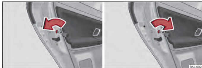
Fig. 11 Enclenchement de la protection pour les enfants : pour les véhicules sans ou avec verrouillage centralisé
