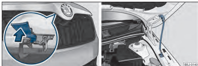
Fig. 127 Calandre: Levier de fixation/Fixation du capot-moteur avec appui du capot
