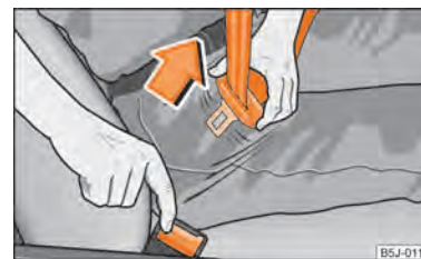
Fig. 101 Enlever le pêne du boîtier de verrouillage
