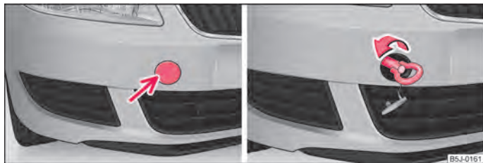
Fig. 149 Pare-chocs avant: Cache/pose de l'oeillet de remorquage
