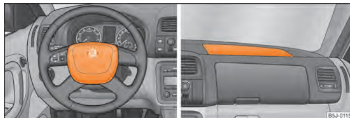
Fig. 102 Airbag conducteur dans le volant/airbag passager avant dans le tableau de bord
