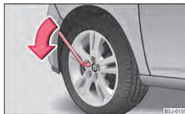
Fig. 142 Changement de roue: Desserer les boulons de roue
