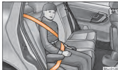
Fig. 115 Siège pour enfant monté sur le siège arrière dans le sens de déplacement du groupe 3
