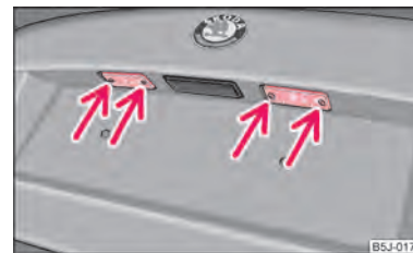
Fig. 164 Déposer l'éclairage de la plaque d'immatriculation
