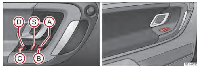
Fig. 19 Touches dans la porte du conducteur/touches dans les portes AR
