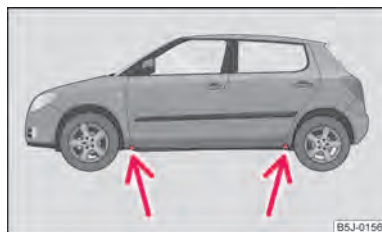
Fig. 143 Changement de roue: Points d'appui du cric
