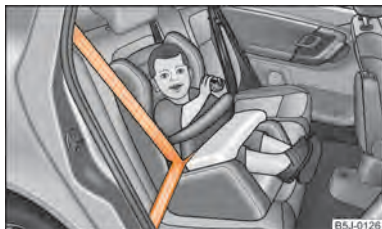
Fig. 113 Siège pour enfant monté à l'arrière dans le sens de déplacement avec tablette de sécurité du groupe 1
