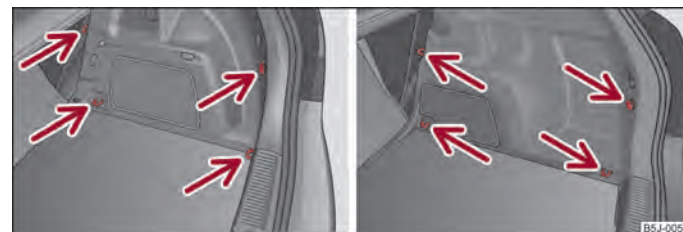
Fig. 44 Coffre à bagages: Oeilletons d'arrimage et éléments de fixation (Fabia)/(Combi)
