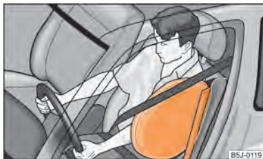
Fig. 106 Airbag latéral rempli de gaz
